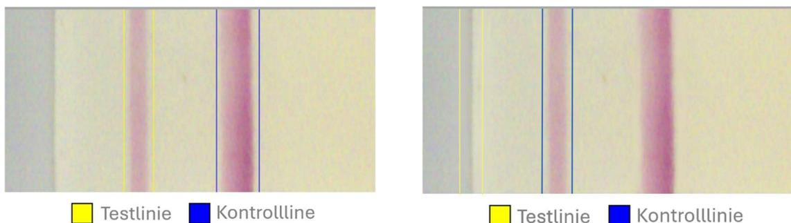
Abb. 2: Bandenerkennung valide    Abb. 3: Bandenerkennung invalide
