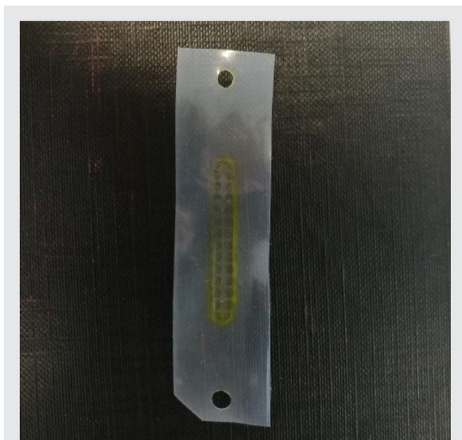
Fig. 10: Deterioramento della membrana di KOBRA® CELL
