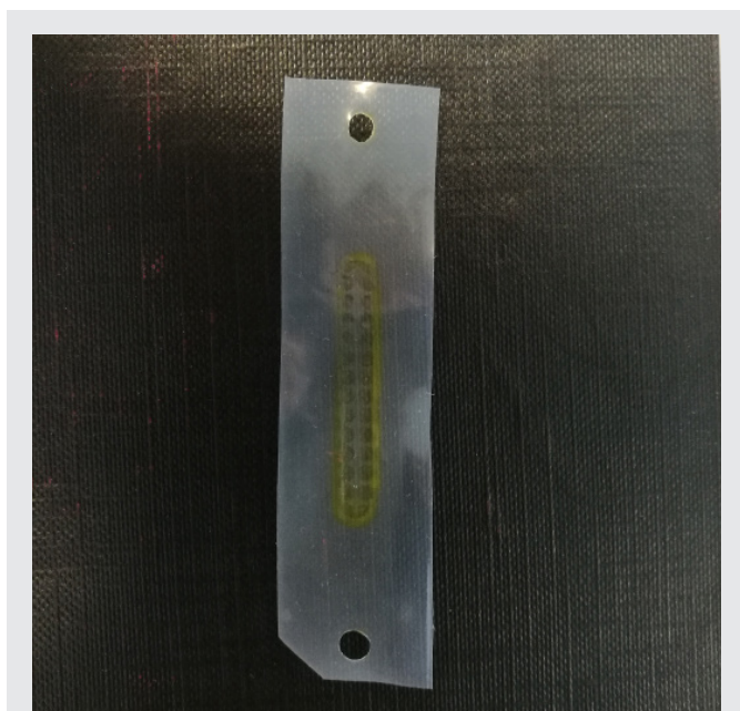
Fig. 10: Deterioramento della membrana di KOBRA® CELL
